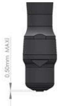
✚ Vérifier à vide le fonctionnement du système de verrouillage. Vous devez entendre et ressentir le « clic » de la bille de verrouillage. Armer et appuyer sur le taquet de tir pour vérifier le bon fonctionnement du percuteur
